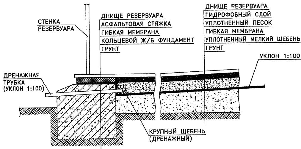
Рис. 10.3. Кольцевой железобетонный фундамент
