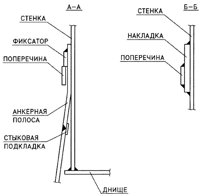
Рис. 8.17. Крепление стенки анкерными полосами
