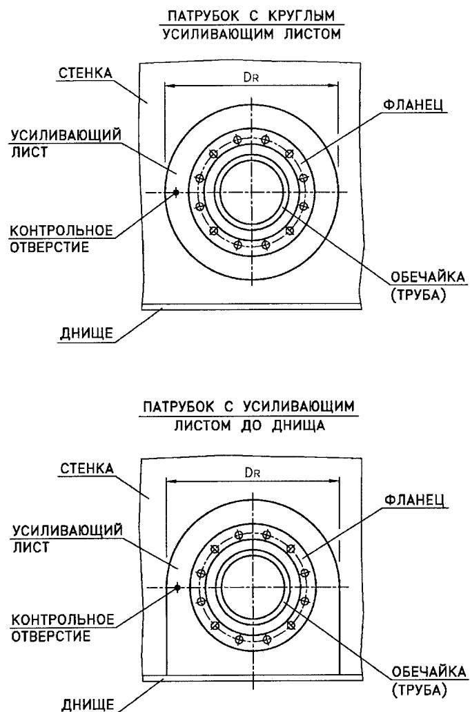
Рис. 8.6. Патрубки в стенке. Общие виды
