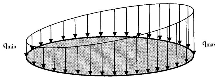
Рис. 10.1. Нагрузки на фундамент, передаваемые по контуру стенки резервуара
