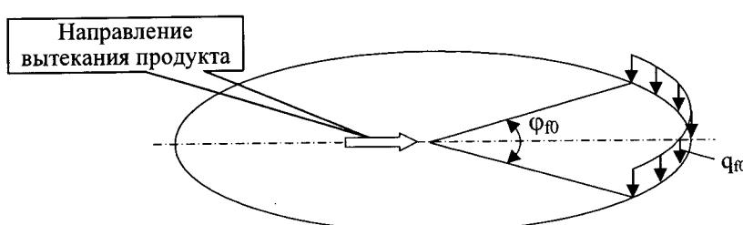
Рис. П.17.2 Схема приложения нагрузки к защитной стенке резервуара и ее фундаменту в условиях аварии
