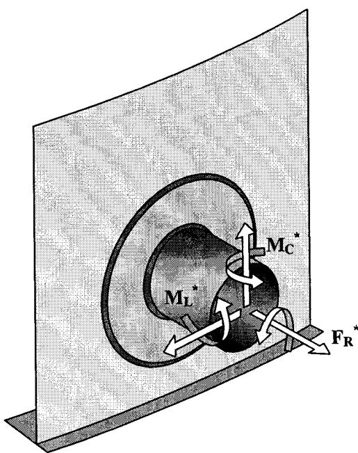
Рис. 9.6. Нагрузки на патрубок врезки в стенку резервуара
