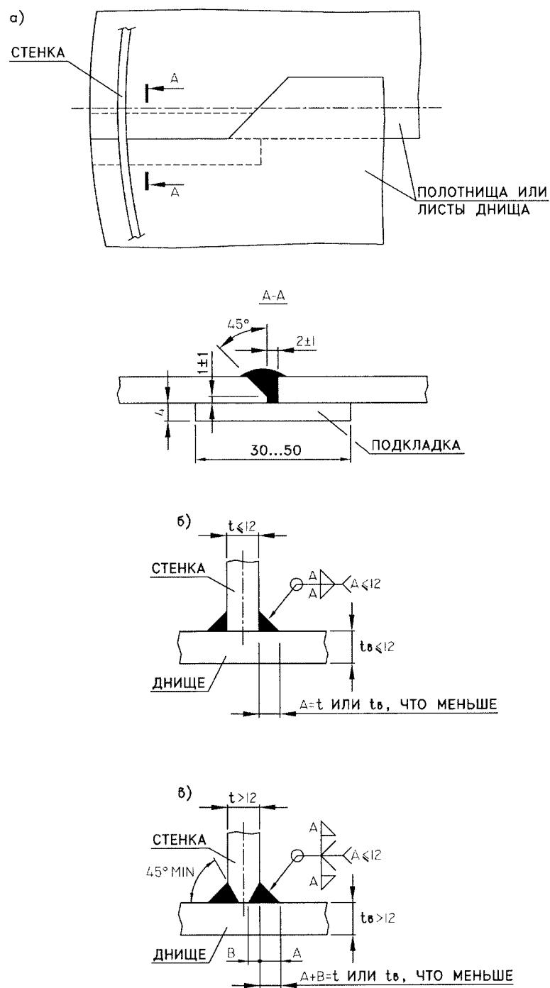
Рис. 8.1. Соединение днища со стенкой
