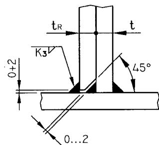
Рис. 8.4. Детали патрубков и люков-лазов в стенке
