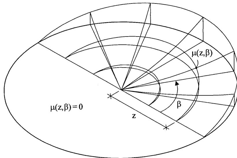
Рис.9.2. Неравномерное распределение снеговой нагрузки на стационарной крыше
