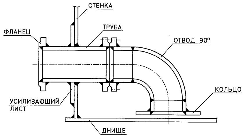
Рис. 8.18. Патрубки зачистки с отводом
