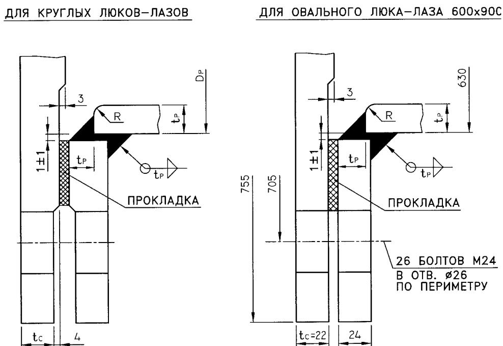
Рис. 8.11. Соединение фланца люка-лаза с обечайкой и крышкой
