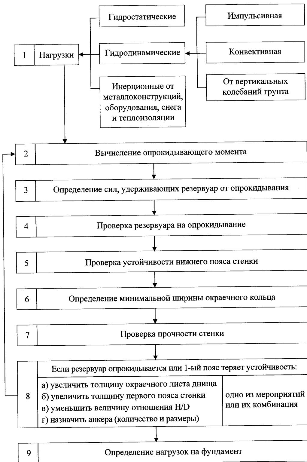
Рис. 9.8. Последовательность расчетов сейсмостойкости резервуара
