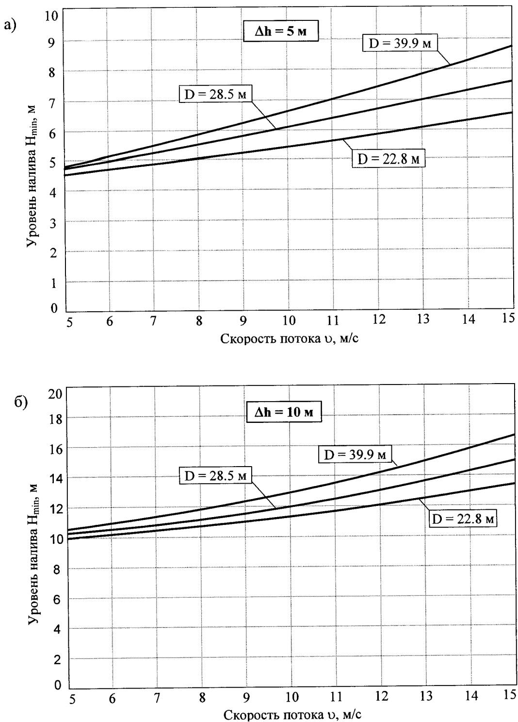
Рис. П.8.1 Определение уровня налива  $H_{\min}, \text{ м}$ а) высота потока  $\Delta h = 5 \text{ м}$ б) высота потока  $\Delta h = 10 \text{ м}$
