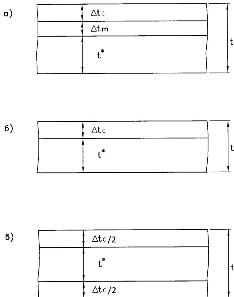
Рис. 7.1. Номинальные толщины проката конструктивных элементов резервуара, контактирующих с продуктом или его парами
