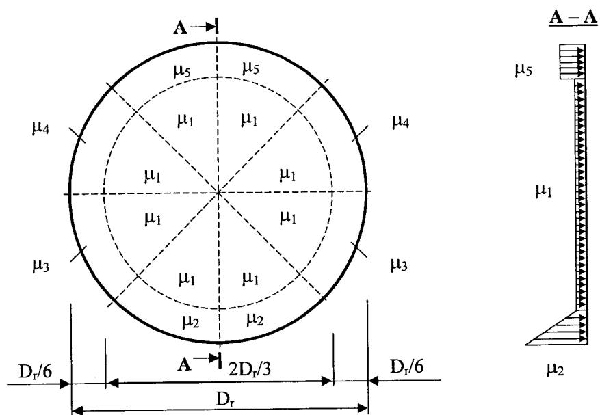
Рис.9.4. Неравномерное распределение снеговой нагрузки на плавающей крыше
