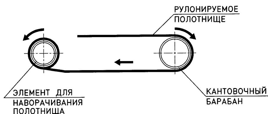
Рис. 16.1. Схемы сворачивания рулонируемых полотнищ
