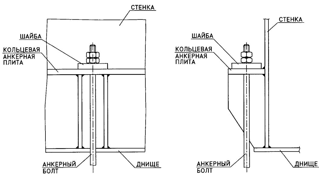
Рис. 8.16. Крепление стенки анкерными болтами
