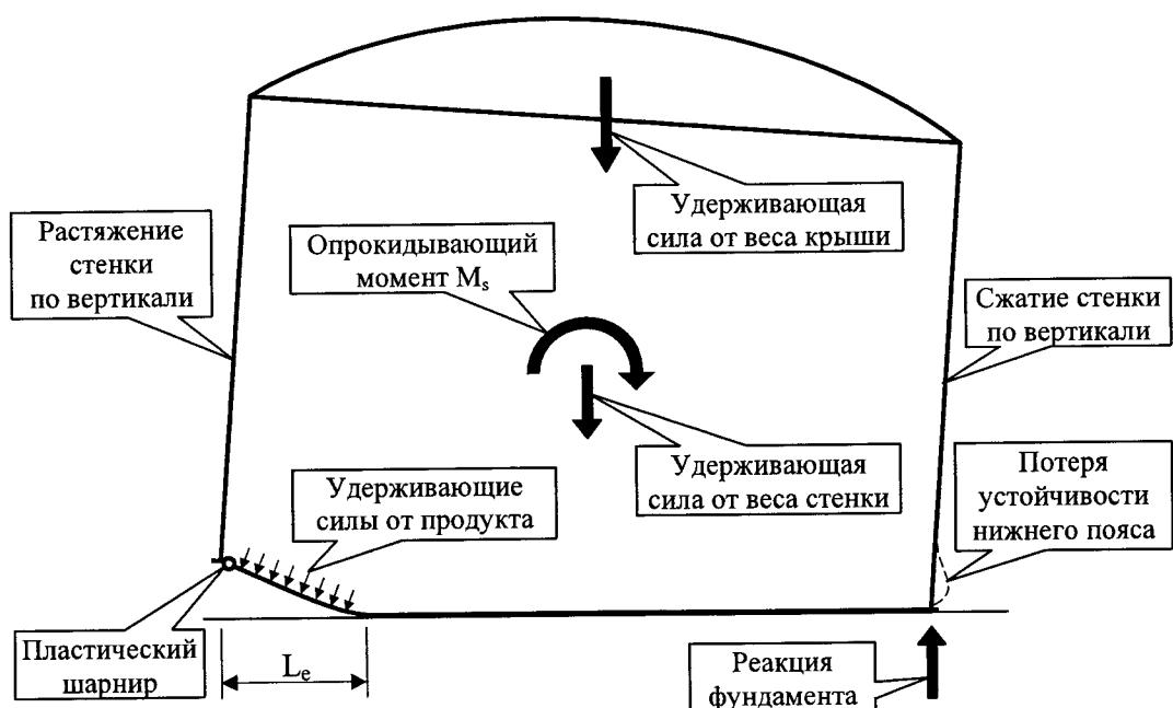
Рис. 9.9. Расчетная схема резервуара в условиях землетрясения
