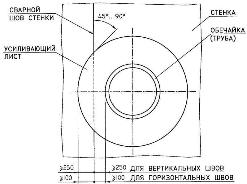
Рис. 8.5. Установка патрубков и люков в местах пересечения со сварными швами стенки (вертикальными или горизонтальными)
