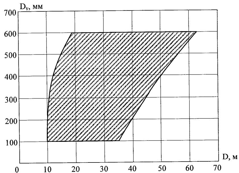
Рис.9.5. Область допускаемых размеров патрубков  $D_y$  для раздела 9.5
