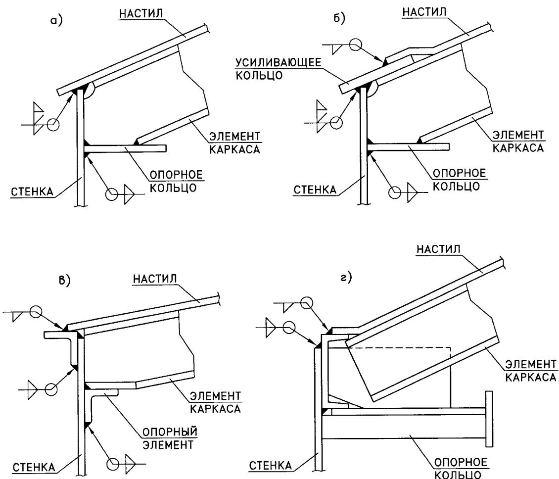
Рис. 8.3. Соединение каркасных конических или купольных крыш со стенкой
