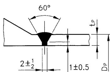
Рис. 8.8. Соединение фланца и патрубка с обечайкой (трубой)
