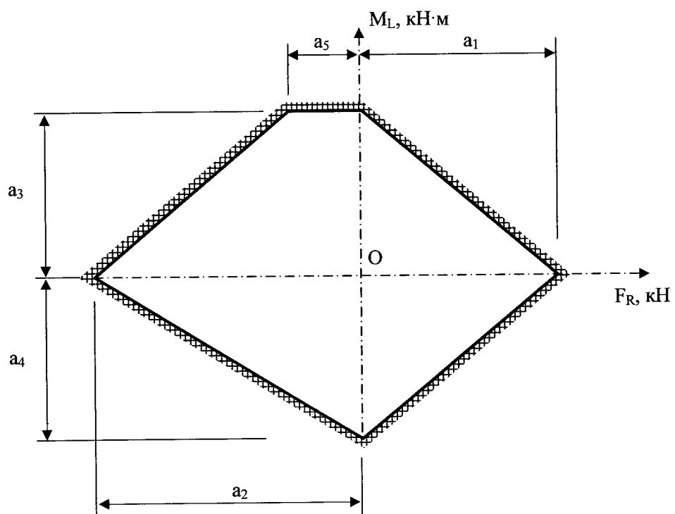
Рис.9.7. Область допускаемых нагрузок на патрубки
