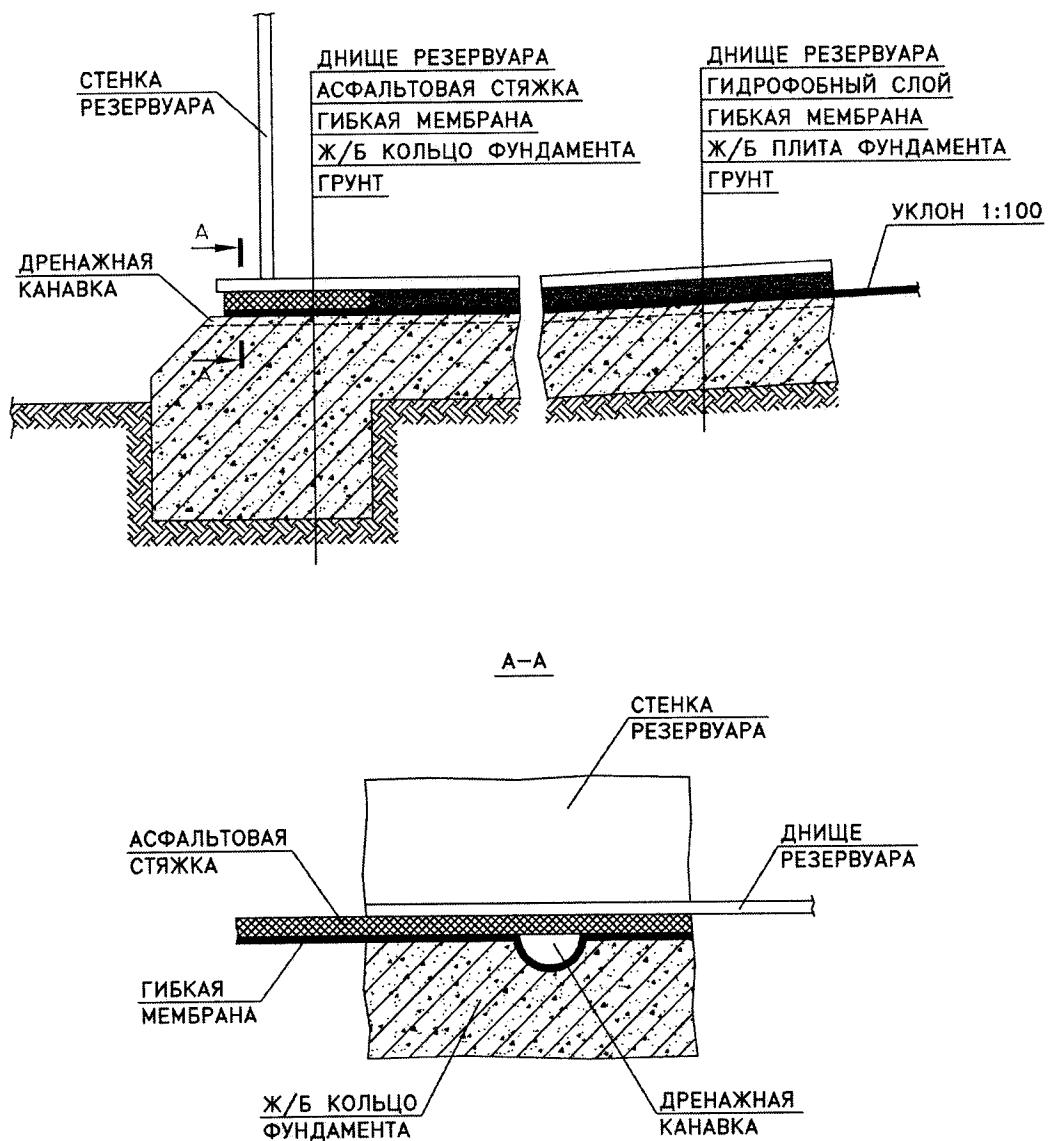
Рис. 10.4. Сплошная железобетонная плита
