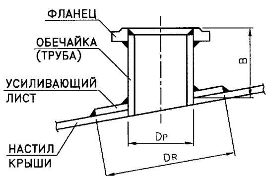
Рис. 8.12. Патрубки в крыше
