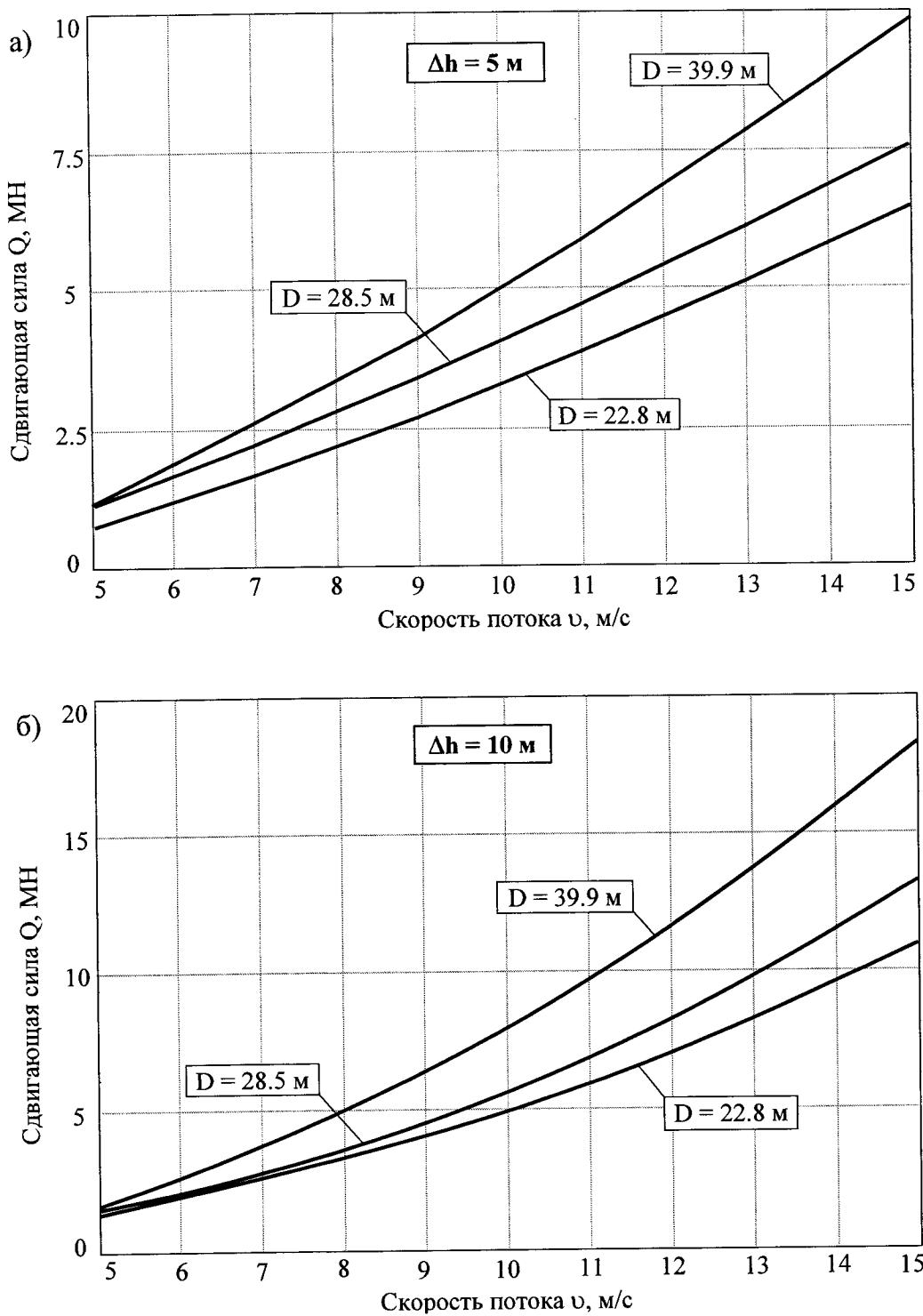
Рис. П.8.2 Определение сдвигающей силы  $Q$ , МН
