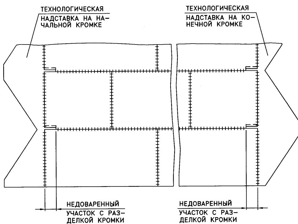
Рис. 16.2. Технологические надставки рулонируемых полотнищ стенки
