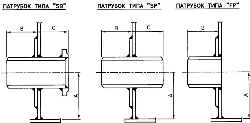
Рис. 8.7. Патрубки в стенке. Разрезы
