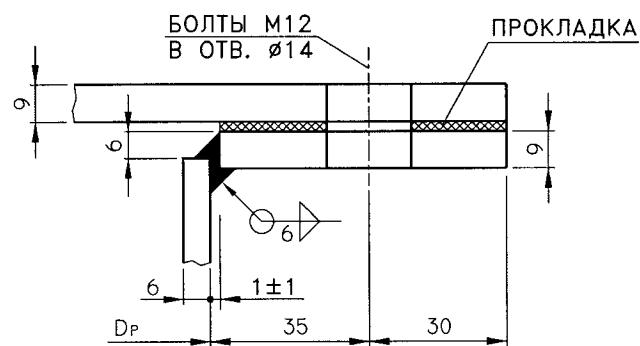
Рис. 8.13. Детали патрубков и люков в крыше
