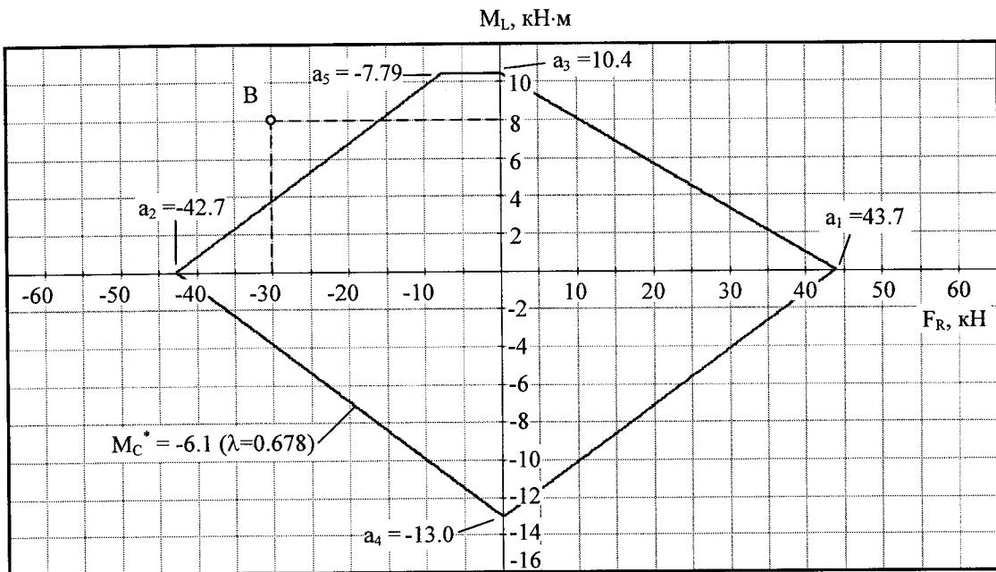
Рис. П.18.2. Область допускаемых нагрузок на патрубок при  $M_C^* = -6.1 \text{ кН}\cdot\text{м}$
