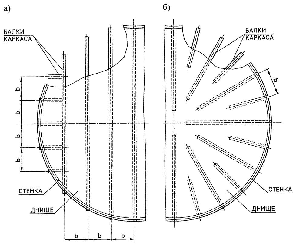
Рис. П.19.1 Схемы расположения опорных балок днища
